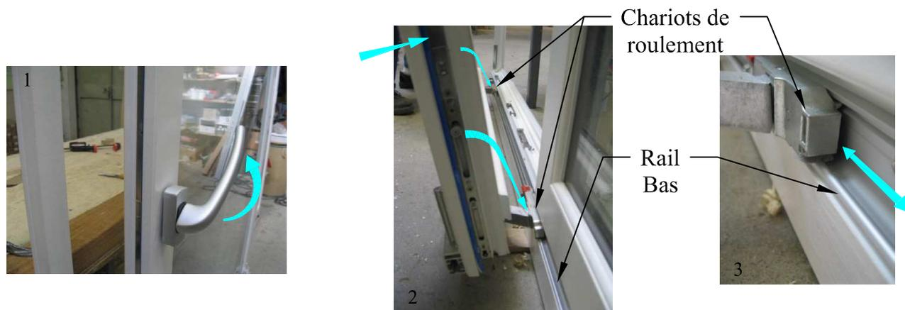
1 - Poser le vantail (poignée en bas) sur des cales de bois face au dormant, à environ 15 cm de celui-ci. (les cales doivent être à la même hauteur que le dessous du rail).
